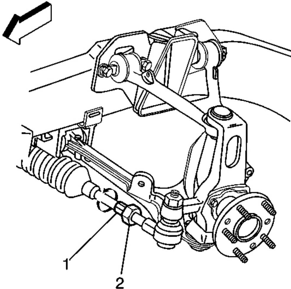
**Fig. 2: Jam Nut & Inner Tie Rod**
